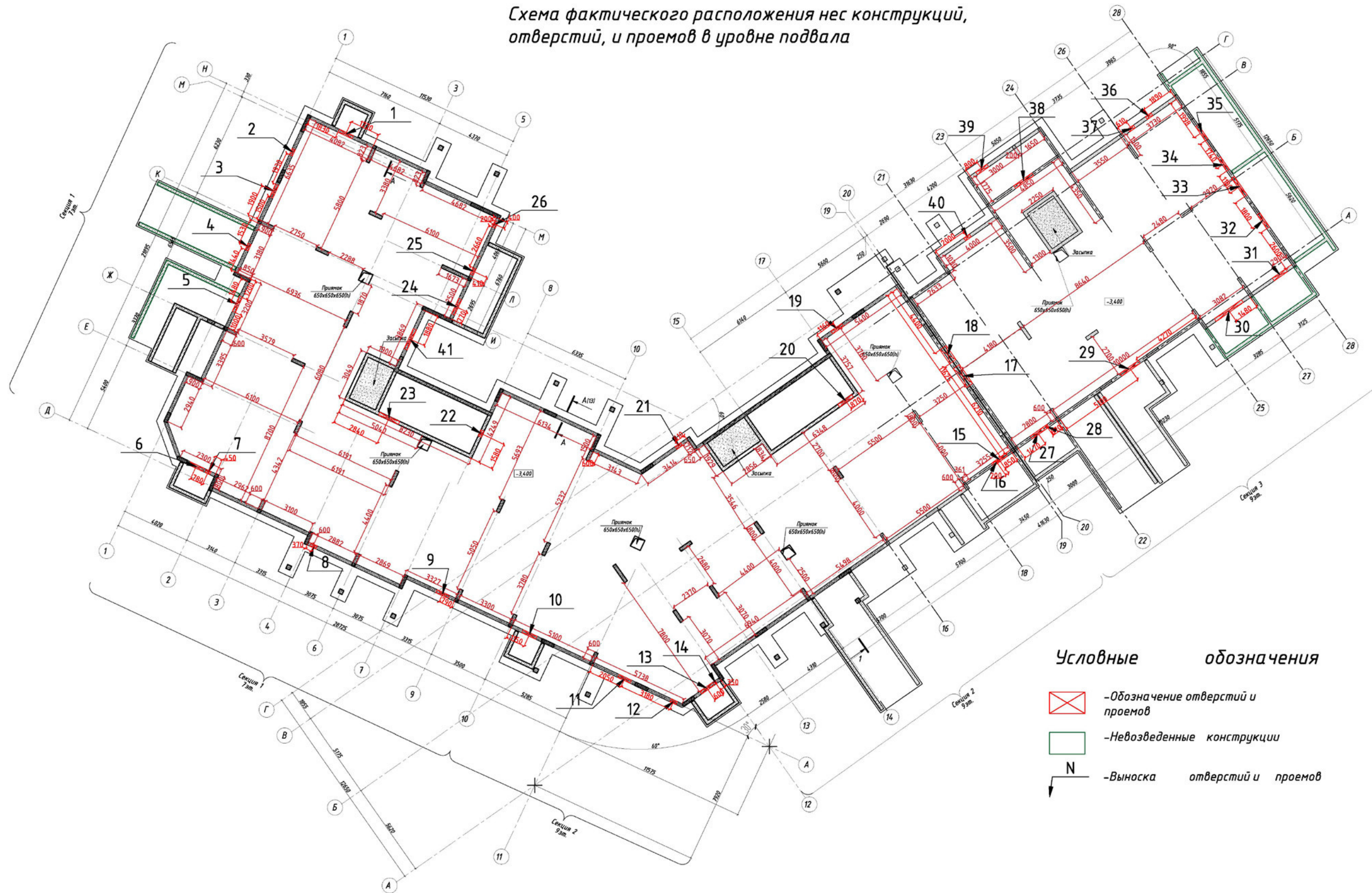
Рис. 2. Схема фактически возведенных конструкций.
