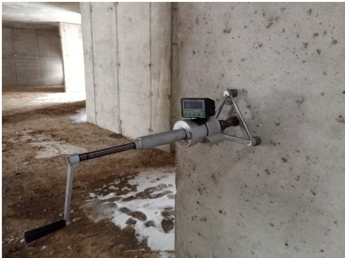
Рис. 4.2.2. Установка прибора «ПОС-50МГ4»
